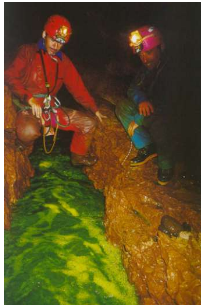
Immissione di fluoresceina (foto M. Pappacoda)
