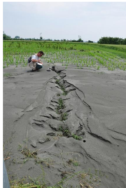
Emilia, sisma 2012, fenomeni di liquefazione; (da http://www.3bmeteo.com/gallery ).
