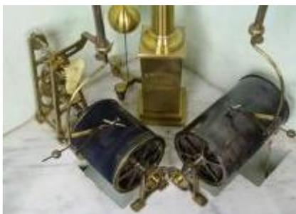
**21 gennaio 2013** - Un sismoscopio a mercurio del 1784, un tromometro a prisma del 1875, un microsismografo a doppio pendolo del 1894. E ancora: un razzo antigrandine della seconda metà del Ventesimo secolo, uno psicrometro a fionda di inizio Novecento e un solarimetro registratore del 1924.
