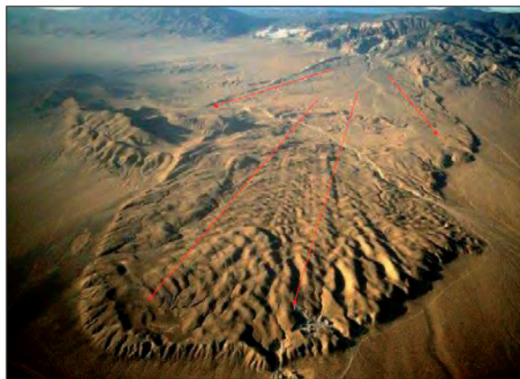
Figura 11 – La frana di Blackhawk in California è caratterizzata da litologie simili a quelle del versante nord occidentale della Sila e da fenomeni di deformazione e sollevamento di una ampia fascia di piede analogamente a quanto riscontrato nel versante nord-occidentale della Sila.
