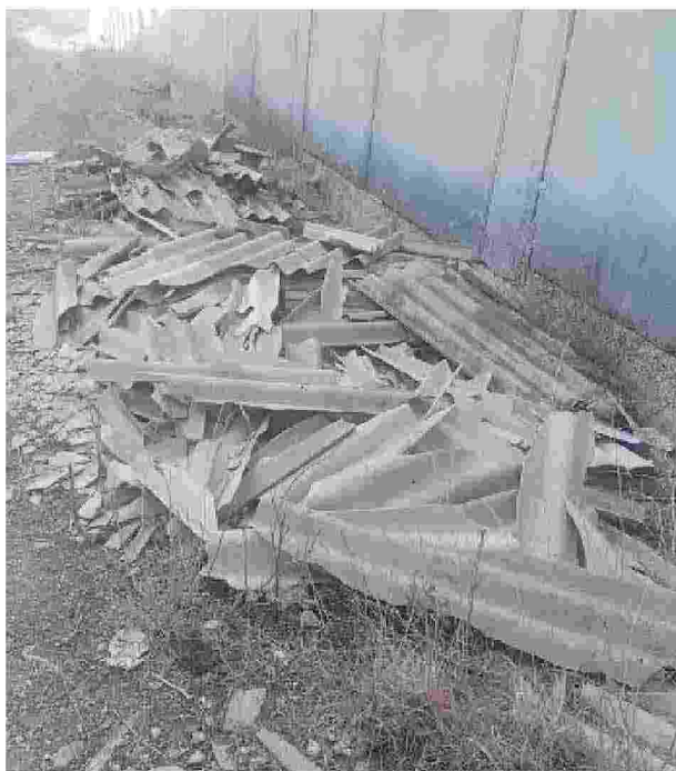
Discarica abusiva di amianto
