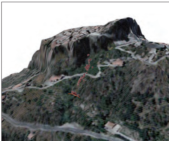
Fig. 8 - 3D punti d'arresto dei massi (vista da NE)
