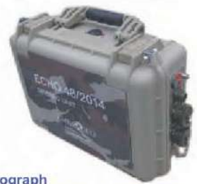
Seismograph ECHO 48/2014 Seismic Unit - 24bit
