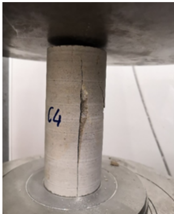
Figura 9 - Provino C4 dopo l'esecuzione della prova a compressione uniassiale, da notare la tipologia di rottura composta da una frattura longitudinale tale da dividere in due parti quasi simmetriche il provino.
