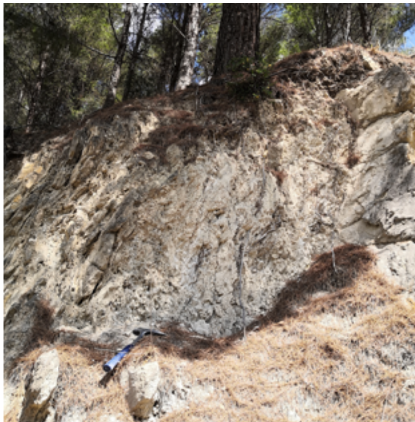
Figura 4 - Zona cataclastica con comminuzione dei granuli dovuta al frizionamento, evidenza dei fenomeni deformativi che in passato hanno interessato l'area.
