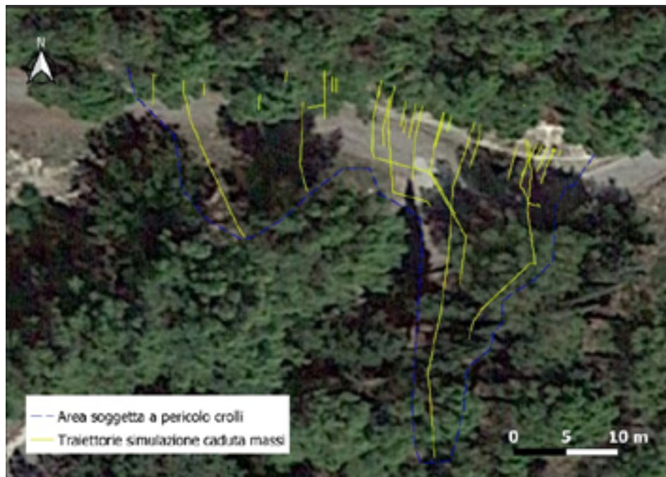
Figura 12 - Traiettorie ottenute dalla simulazione della caduta massi su foto aerea che interessano l'infrastruttura stradale.
