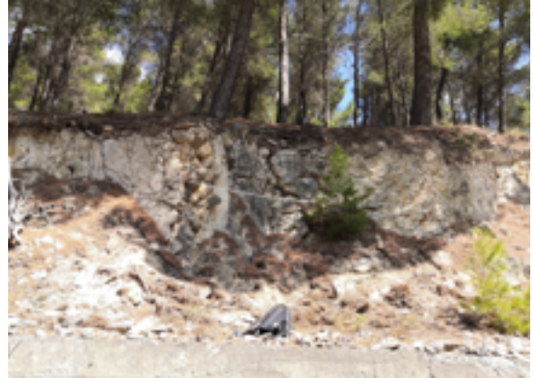
Figura 5 - Scanline SL1, ai piedi del fronte si notano i blocchi di dimensioni decimetriche crollati dall'ammasso.
