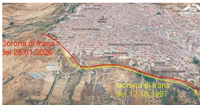
Figura 15 - Raffronto tra la corona di frana del 1997 e quella del gennaio 2026 (da C. Monaco, 2026).
