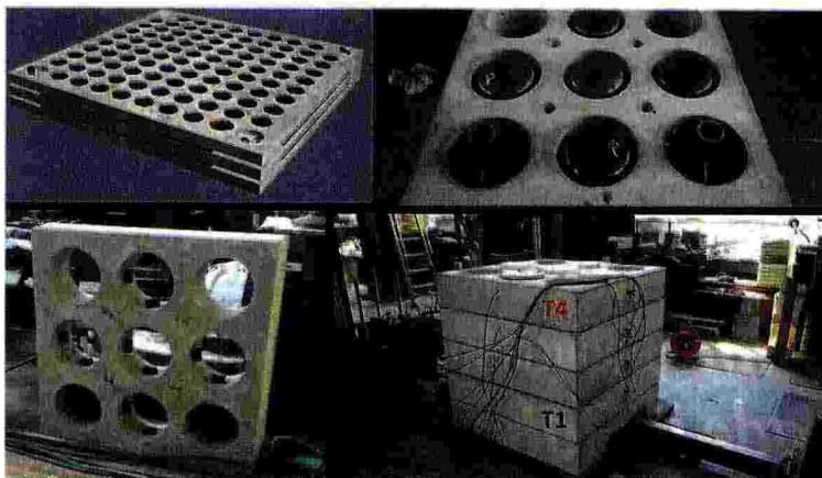
In alto a sinistra un modello 3D di Metacomf (fondazione composita), a destra un prototipo reale ove sono visibili le masse interne; in basso a sinistra un singolo modulo e a destra l'intero dispositivo durante i test di laboratorio. T1 è la piastra basale e T4 il sedime di fondazione dell'edificio.
