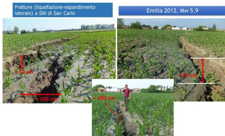
Figura 4. Liquefazione a San Carlo (Reggio Emilia) per il terremoto del 2012 (Mw 5,9).
